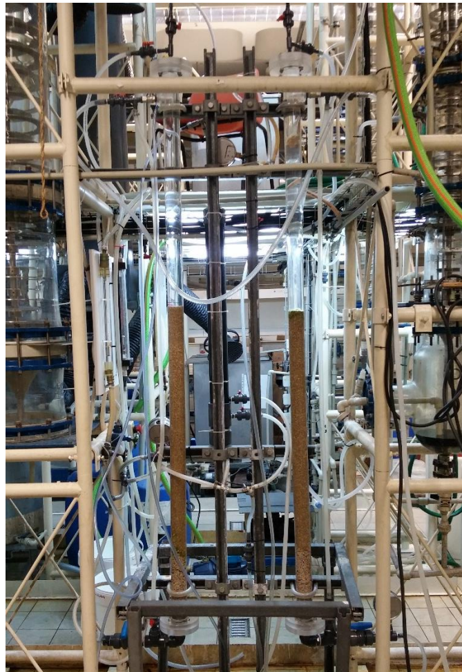
Figura 5 Montagem Experimental das Colunas de d=5,2\text{cm}
