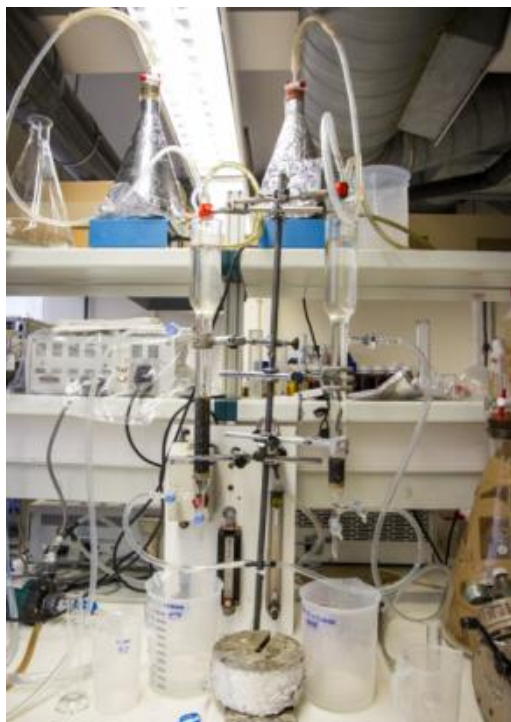
Figura 3 Montagem experimental das colunas d=2,5 cm
