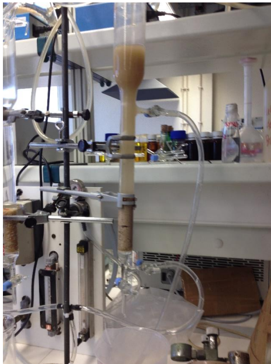
Figura 4 Lavagem do leito de areia, no final de um ensaio
